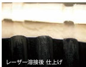
レーザー溶接後 仕上げ
