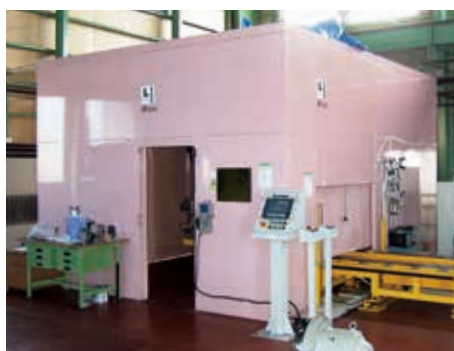
テーラードブランク溶接機(高出力半導体レーザー加工機)
