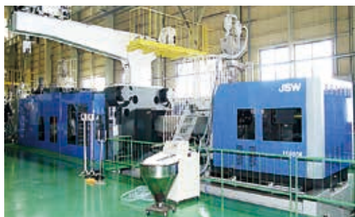
大型電動射出成形機 (2500t・7軸サーボ取出し機付)
