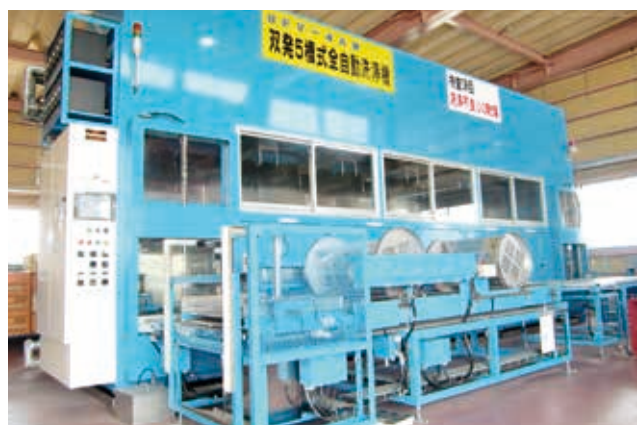
炭化水素系洗浄ライン
