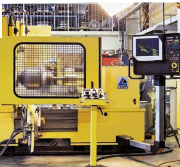
NCスピニングマシン(ブランク径:φ1,050mmまで加工可、板厚:6.0mm(SS材)まで加工可)
