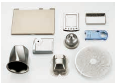
プレス製品サンプル (ステンレス、アルミ、チタン、マグネシウムなど)
