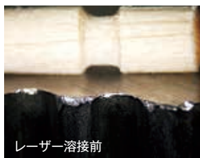
レーザー肉盛溶接による金型補修
